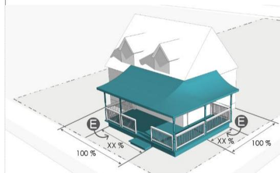
Figure 229. Largeur d'une façade principale occupée par une galerie couverte
