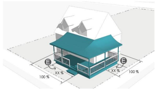
Figure 30. Proportion de la largeur d'une façade principale avant ou avant-secondaire occupée par une galerie couverte
