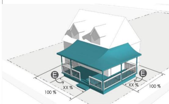
Figure 86. Largeur d'une façade principale occupée par une galerie couverte
