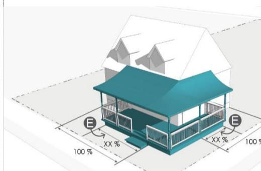
Figure 177. Largeur d'une façade principale occupée par une galerie couverte
